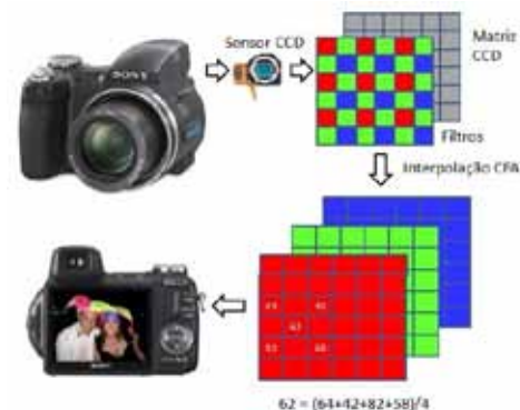
Figura 2. Sensores CCD e Filtros CFA
