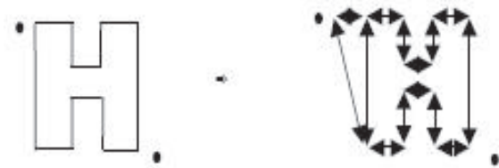
Fig. 4. Construindo um grafo de visibilidade
